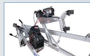
El-spil med wire. Inkl. batteri og batterikasse. Monteret. Warn 4700, Trækkap. 2.132 kg (Varenr. 50189) Kr. 9.675,- Warn Tabor 8K, Trækkap. 3.629 kg (Varenr. 50191) Kr. 11.350,- Trådløs fjernbetjening (Varenr. 41556) Kr. 3.275,-
